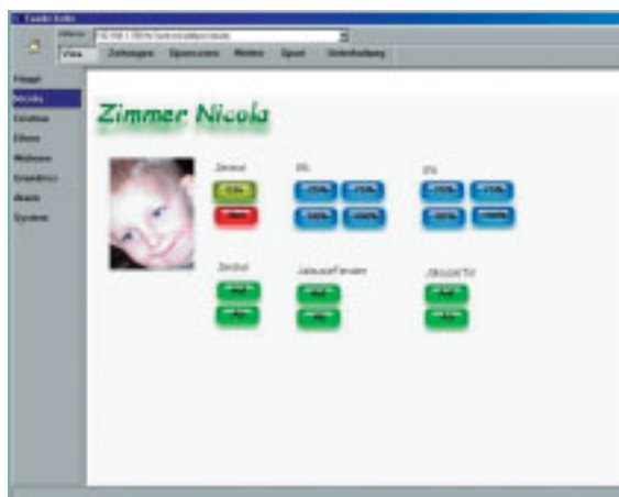
Bild 4: Die Bedienoberfläche auf dem Portable PC für die Szenen in einem Kinderzimmer.
