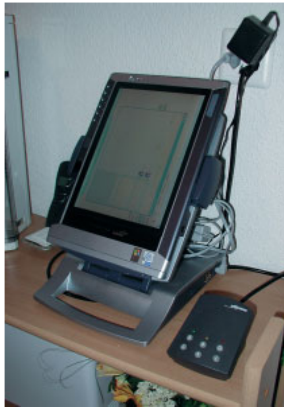
Bild 3: Portable PC in der Lademulde und Entralite (links) für die Bedienung der Hausrufanlage.
