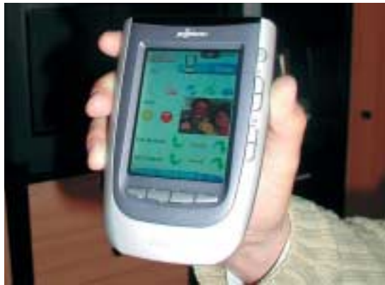
Vernetztes Wohnen dank Bustechnik auch als Nachrüstung: Infrarot-Bedienung für Licht, Jalousien und TV in 30-jähriger Terrassenwohnung. (Bild: EIBROM)
