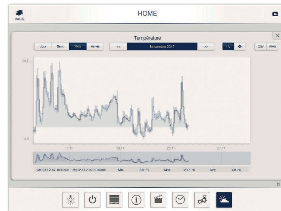
Die Meteostation liefert die registrierten Daten und analysiert diese mit dem Gebäudeautomatisierungssystem.
